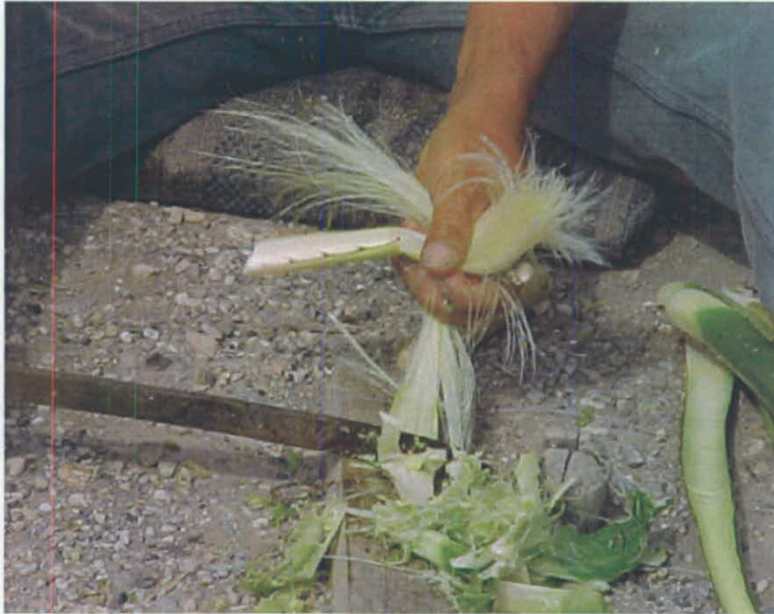
Figura 5. Desfibrado de las hojas de lechuguilla mediante el método manual.
