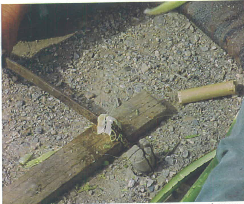
Figura 4. Utensilios rústicos empleados manualmente en el proceso de desfibrado de hojas de lechuguilla.
