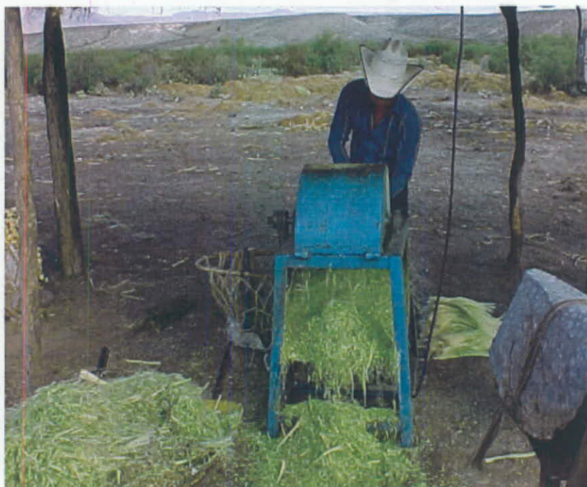
Figura 7. Desfibrado mecánico de hojas de lechuguilla.
