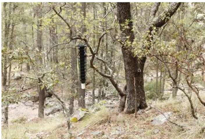
Figura 9. Trampa de embudos Lindgren instalada para el monitoreo de *Dendroctonus mexicanus* y *Dendroctonus frontalis*. La trampa se cuelga con una cuerda, de un árbol no hospederero.
