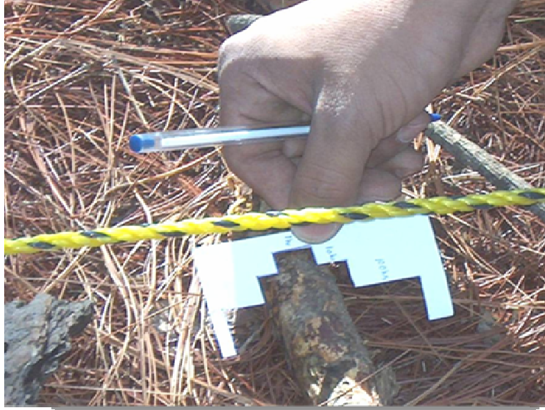
Figura 36 Muestra la medición de combustibles de 10 hora con calibrador.
