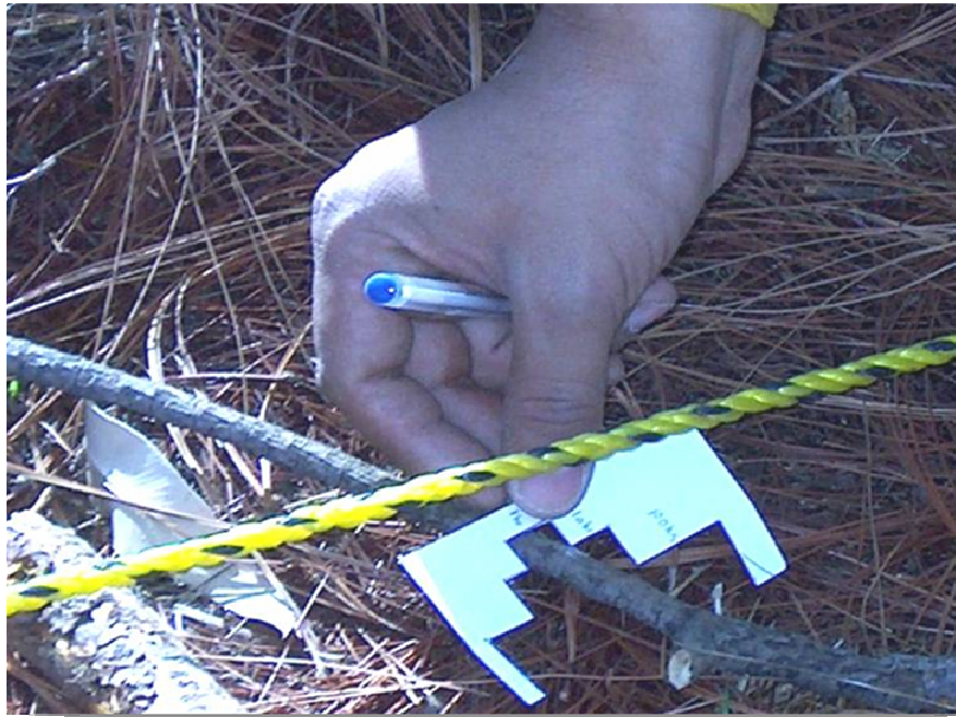
Figura 35 Muestra la medición de combustibles de 1 hora con calibrador.
