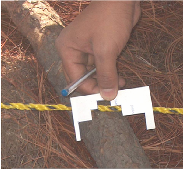
Figura 37 Muestra la medición de combustibles de 100 hora con calibrador.
