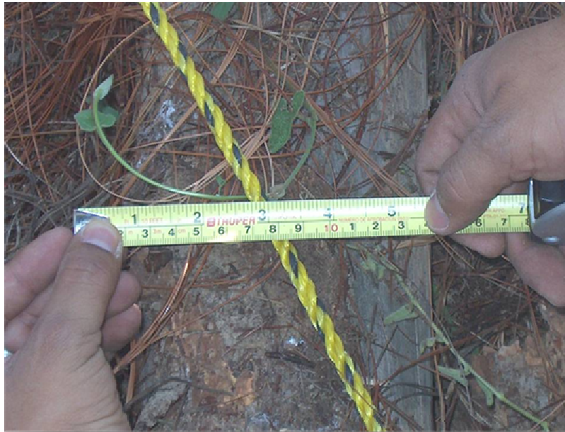
Figura 40 Muestra la medición de combustibles de 1000 hrs. usando flexómetro.
