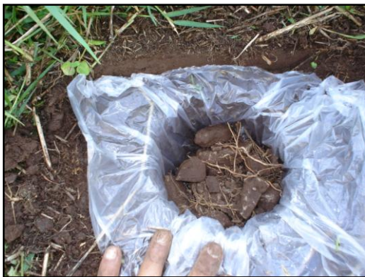
Fotos 9 y 10. Prueba de densidad aparente método "Bolsa Abierta". Note la cantidad de rocas en los primeros 10 cm del suelo. El espacio se rellena con agua para calcular el volumen que estaba ocupado por el suelo.
