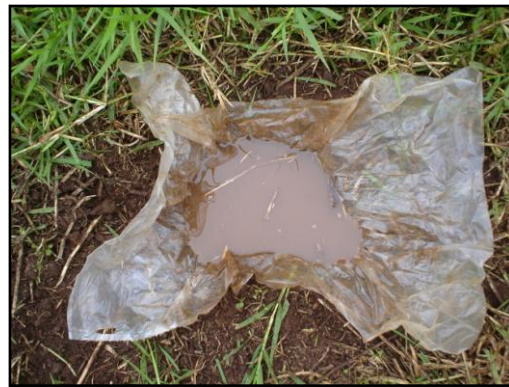
Fotos 9 y 10. Prueba de densidad aparente método "Bolsa Abierta". Note la cantidad de rocas en los primeros 10 cm del suelo. El espacio se rellena con agua para calcular el volumen que estaba ocupado por el suelo.
